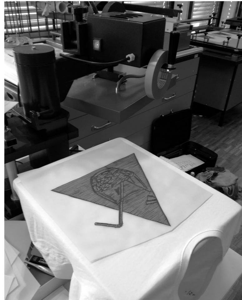
Abb. 16 Auflegen des im Siebdruck auf Transferfolie gedruckten Motivs und anschließendes Aufeinanderpressen bei 160° Grad für circa 25 Sekunden
